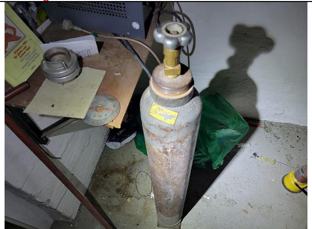
Alte Gasflasche, Inhalt unbekannt, Aufkleber nicht mehr erkennbar, Restdruck enthalten
